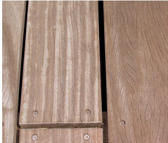
Wechseldrehwuchs ist charakteristisch für viele Tropenhölzer. Der wechselnde Faserverlauf ist je nach Einschnittrichtung an den spiegelnden Streifen (linkes Brett) zu erkennen, bzw. wird in Form keilförmig zulaufender Risse sichtbar (rechtes Brett).
