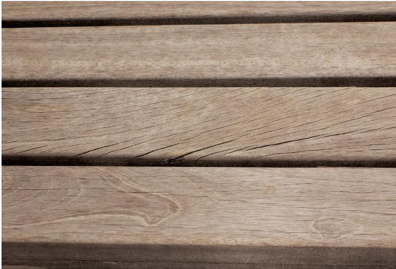
Drehwuchs ist ein um die Stammachse spiralförmig laufender Faserverlauf, der bei frischem Holz schwer zu erkennen ist. Erst mit der Trocknung und damit einhergehender Rissbildung wird der schräge Faserverlauf sichtbar.
