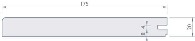
Abschlussdiele , Nutzfläche 0,55 m 2 pro Diele Breite 175 mm, Länge 3.150 mm, Nut einseitig, Kante gerundet
