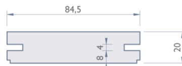
Flächendiele , Nutzfläche 0,26 m 2 pro Diele Breite 84,5 mm, Länge 3.150 mm, Nut beidseitig
